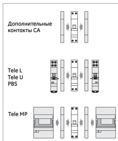
Для подключения дополнительных устройств (Tele L, Tele U, PBS) к миниатюрным автоматическим выключателям сначала необходимо установить универсальный дополнительный контакт CA.
